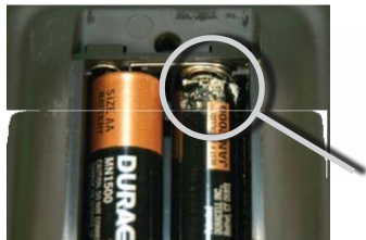
La corrosion que vous POUVEZ voir
