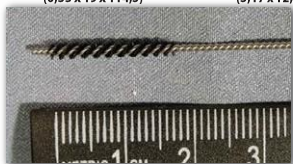
Brosse, acier inoxydable, référence B-S5116 (diamètre: 1,58 mm, longueur: 101 mm)
